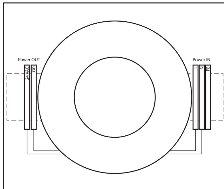
**Applikation / Anwendung** Spannungsversorgung von bis zu 24 Stk. FSC-UFC-Geräten mit den dazugehörigen Antrieben und Rauchmeldern. Abhängig vom UFC-Typ, Leistungsverbrauch der Antriebe, der Leitungslänge etc.
