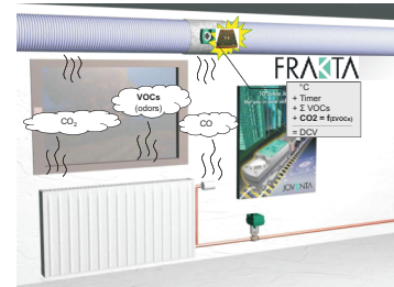
Lüftung mit VOC Sensor
